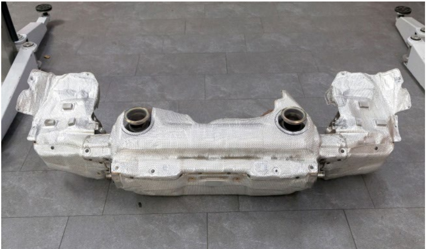
OEM Abgasanlage ausgebaut mit Hitzeschutz OEM exhaust system with heat protection
