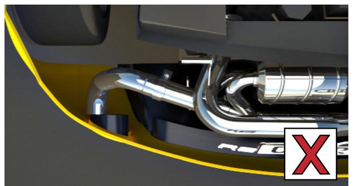
**Abgasanlagen, die in die Schürze münden, müssen zu dem Eingang der Endrohrblende zentriert werden.**
