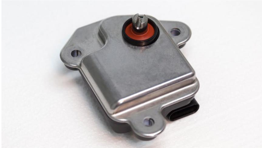
Nachdem die Zündung des Fahrzeugs ausgeschaltet wurde, befindet sich der Aktuator in der gezeigten Stellung und muss in dieser verbleiben.
