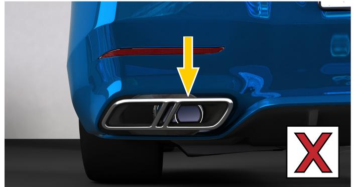
**Ausgang der Abgasanlage zum Eingang der Blende zentrieren.**
