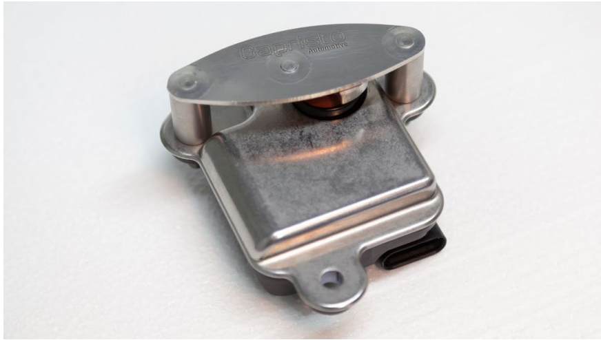
Endlagenplatte aufstecken. Put on the bracket plate.
