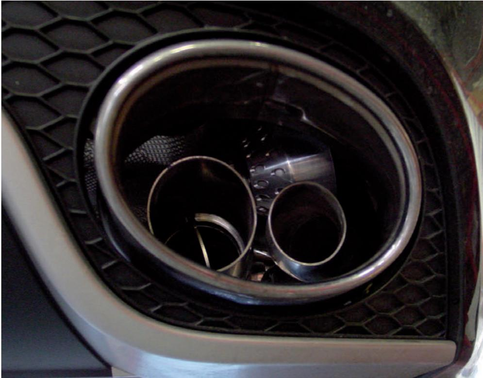
Achten Sie darauf, das die Anlage soweit wie möglich nach vorne geschoben wird, damit Sie durch die Wärmeausdehnung nicht nach hinten anschlägt.
