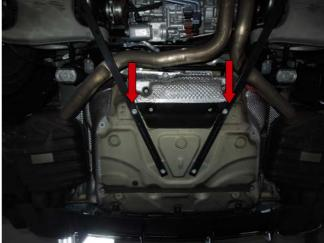
Mittelstrebe und hintere Querstreben demontieren.
