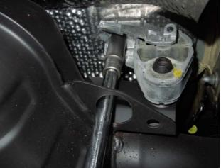
Stecker der Serien Abgasklappenmotoren abziehen und die kompletten Gummi-halterungen der Endtöpfe ab schrauben, die Gummihalterungen an gleicher Stelle an Capristo Austauschanlage montieren.
