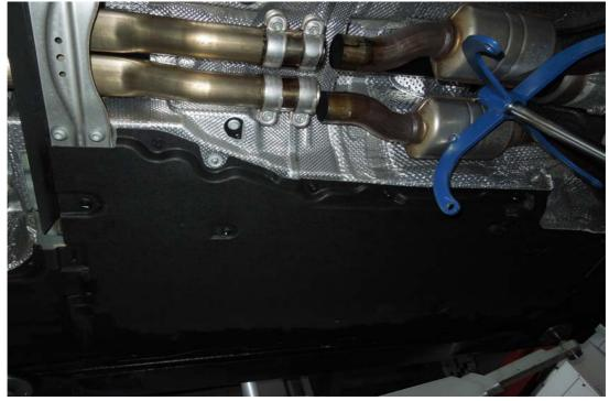
Serienanlage an der Trennstelle hinter den Katalysatoren abziehen, die Serienverbindungsschellen werden nicht mehr benötigt. Um eine Beschädigung der Flexrohre zu vermeiden, sollten die Vorschalldämpfer mit einer geeigneten Vorrichtung abgestützt werden.
