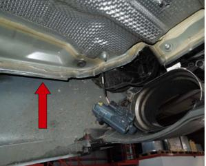
Die Motoren der Serienanlage demontieren und an die originalen Stecker anschließen, die Motoren anschließend mit zwei Kabelbindern im Hohlraum der Seitenwand an der runden Kunststoffhalterung fixieren. Hierbei ist darauf zu achten das die Abtriebswellen der Motoren frei drehen können.
