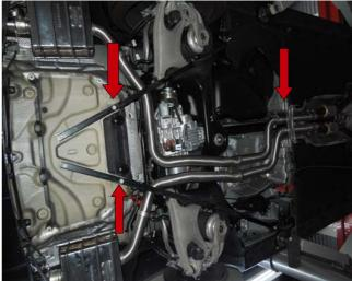
Die Streben werden jetzt wieder montiert und die Austauschanlage so ausgerichtet und fixiert, das zu den vorhandenen Fahrzeugteilen genügend Abstand besteht und ein Anschlagen an diese Bauteile verhindert wird.
