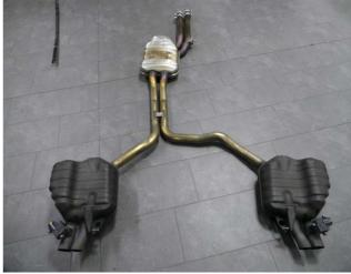
Jetzt die Serienanlage aus den mittleren Haltegummis drücken und vom Fahrzeug ab nehmen, dabei zu erst vorne etwas absenken und dann schräg nach vorne aus dem hinteren Stoßfänger heben.
