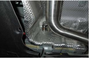
Die Anlage vorne mittels der Rohradapter mit den originalen Rohren verbinden und in den mittleren Gummihalterungen einhängen.
