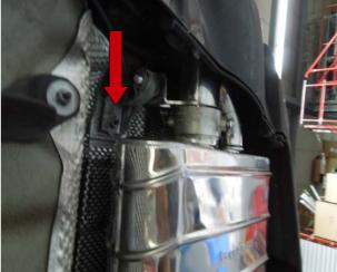
Capristo Austauschanlage auf dem Boden zusammen stecken und die Rohrschellen leicht vorspannen, so das sich die Komponenten noch verdrehen und verschieben lassen. Die Abgasanlage entgegen der Demontage schräg nach hinten in den Stoßfänger ein heben und die Gummihalterungen der Endtöpfe am Unterboden anschrauben.
