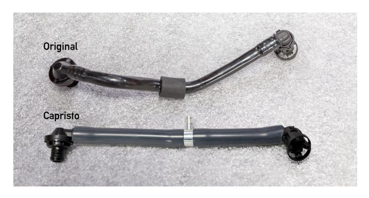
1. Entfernen Sie den Werks-Schlauch von den Steckern (die werden wiederverwendet)./Cut off the original hose from the plugs (we will use them again).
