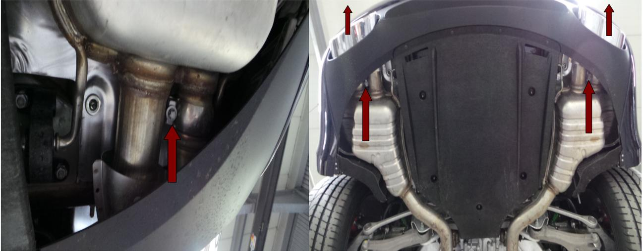
Befestigungsschellen der originalen Endrohre maximal lösen und danach die Endrohre vorsichtig nach hinten aus dem Stoßfänger heraus ziehen. Die originalen Endrohre werden wiederverwendet.
