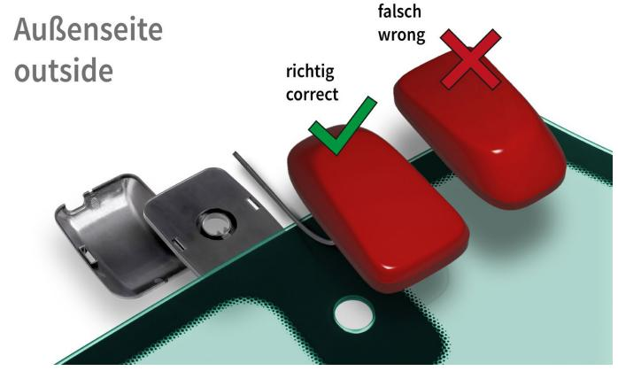
Anordung und Ausrichtung der Komponenten von der Aussenseite aus gesehen. Arrangement and directions of the parts as seen from the outside.
