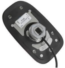
Demontieren Sie die OEM-Antenneneinheit und zerlegen Sie die Mutter, wie gezeigt. Den Kunstoffring anheben und entfernen. Die Mutter selber wird wiederverwendet.
