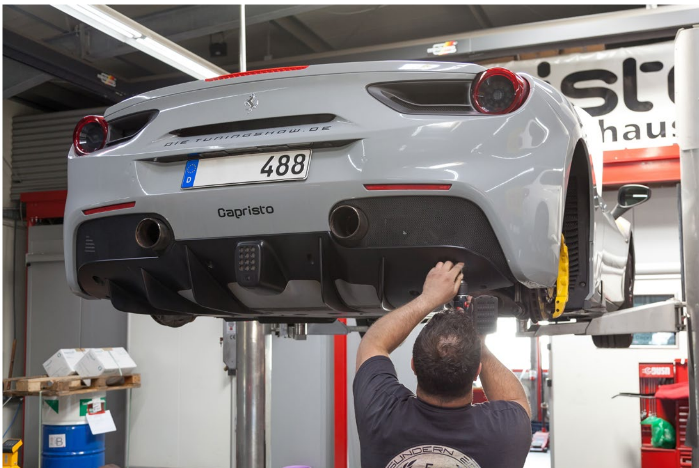
Diffusor abmontieren. / Remove the diffusor.
