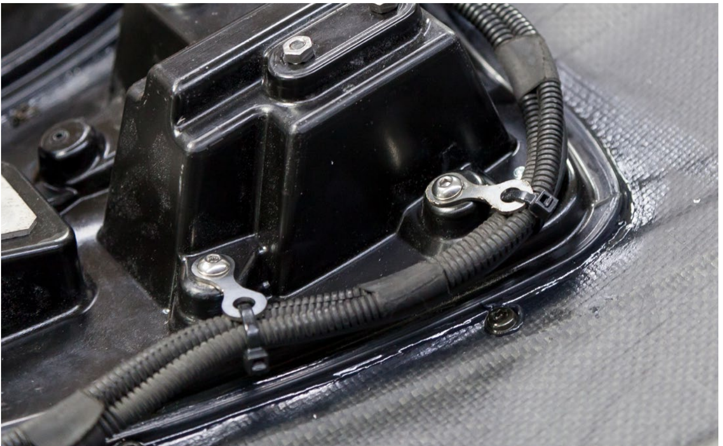
Kabel werden mithilfe der mitgelieferten Ösen und Kabelbinder befestigt. / Harness will be fixed by the delivered eyelets and cable ties.
