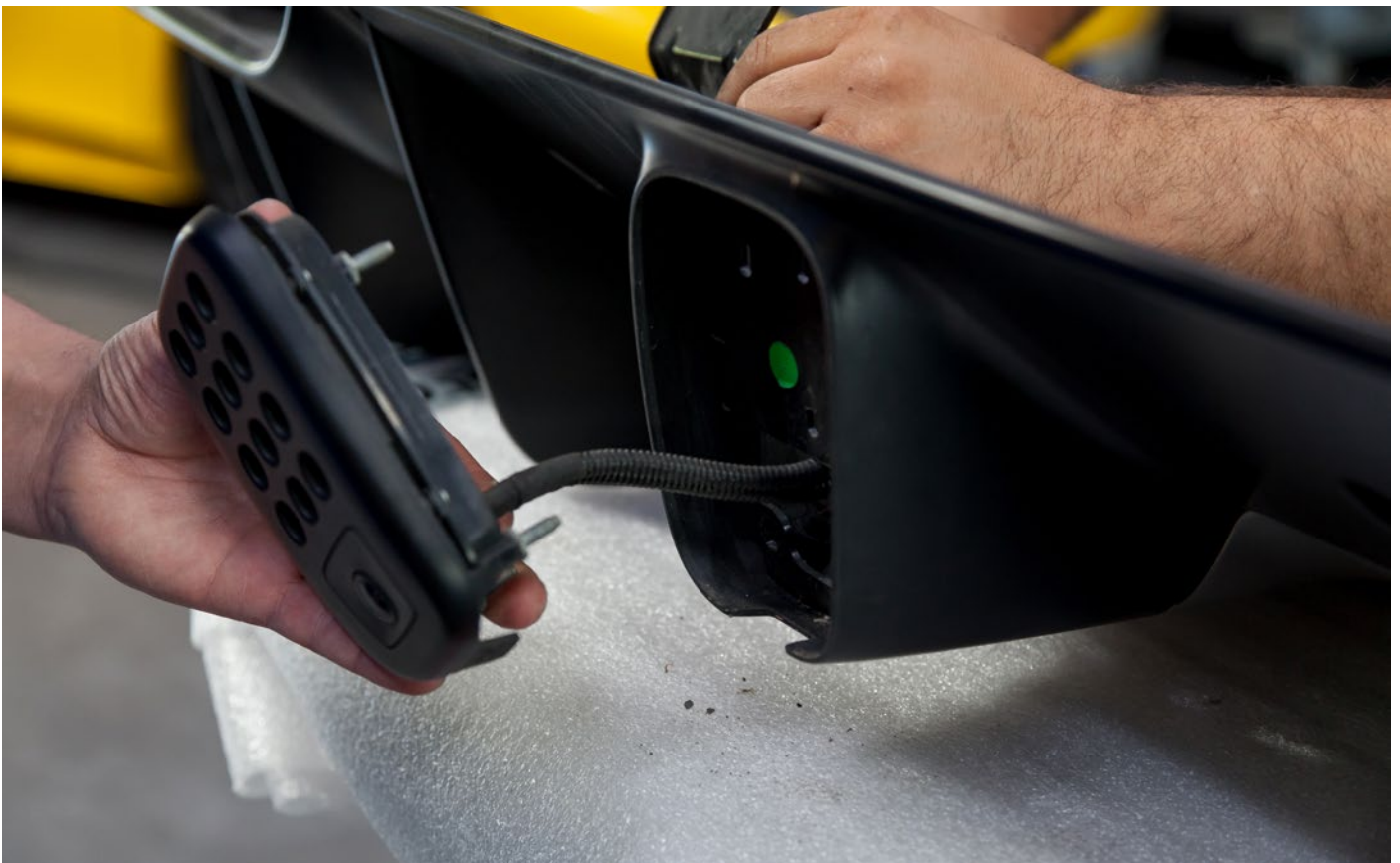
Kamera-Bremslichteinheit demontiert. / Dismounted cam-brake light unit.
