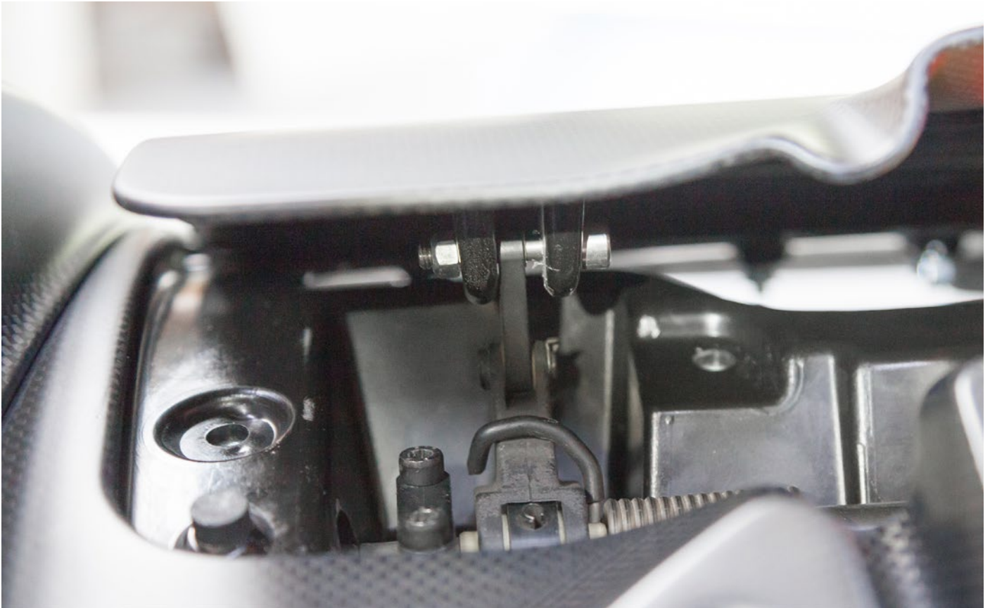
Lasche einer Klappe verbunden mit dem Hebel der Achse. / Lugs of a flap are connected with the crank of the axis.
