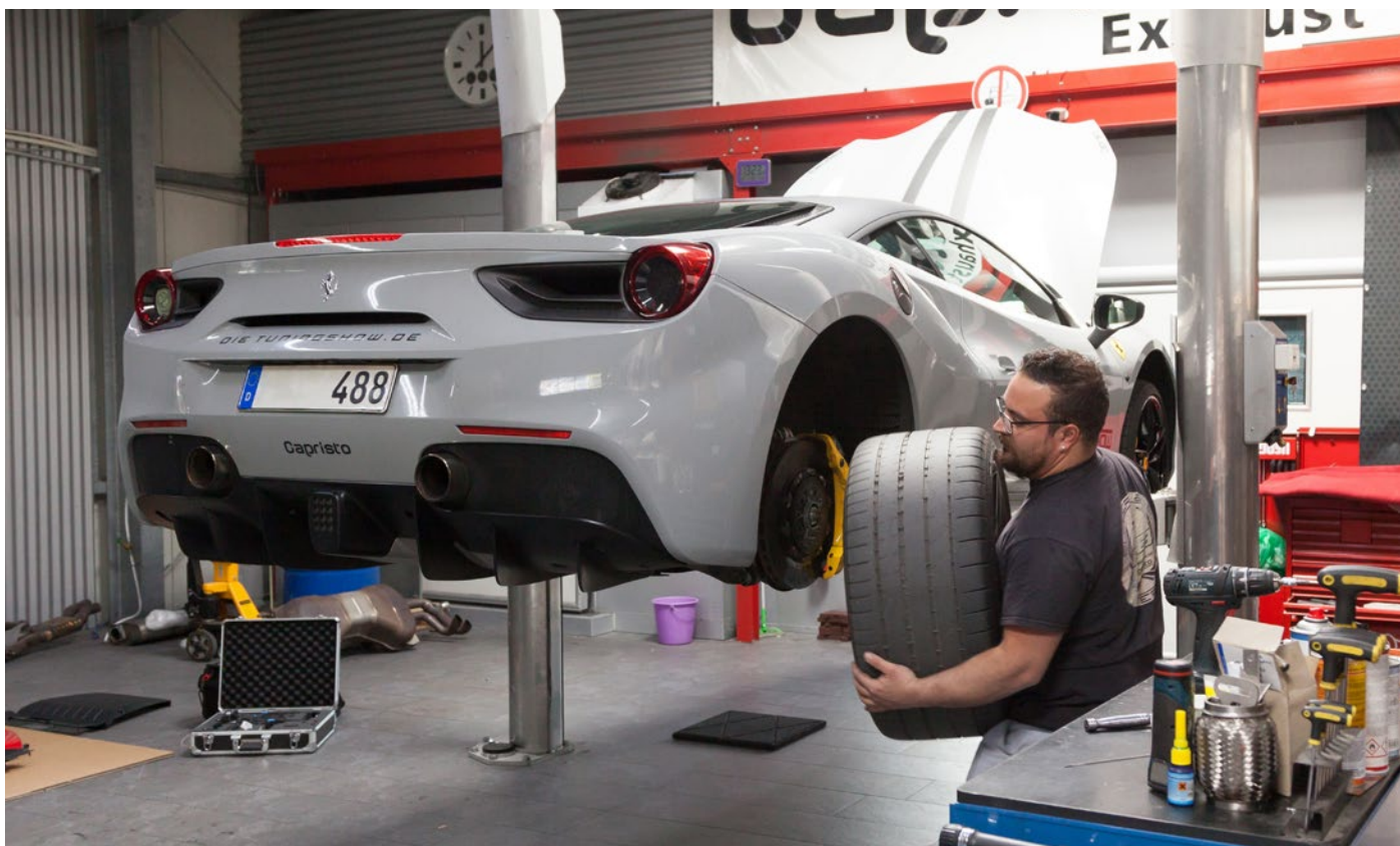
Räder hinten abmontieren. / Remove the rear wheels.
