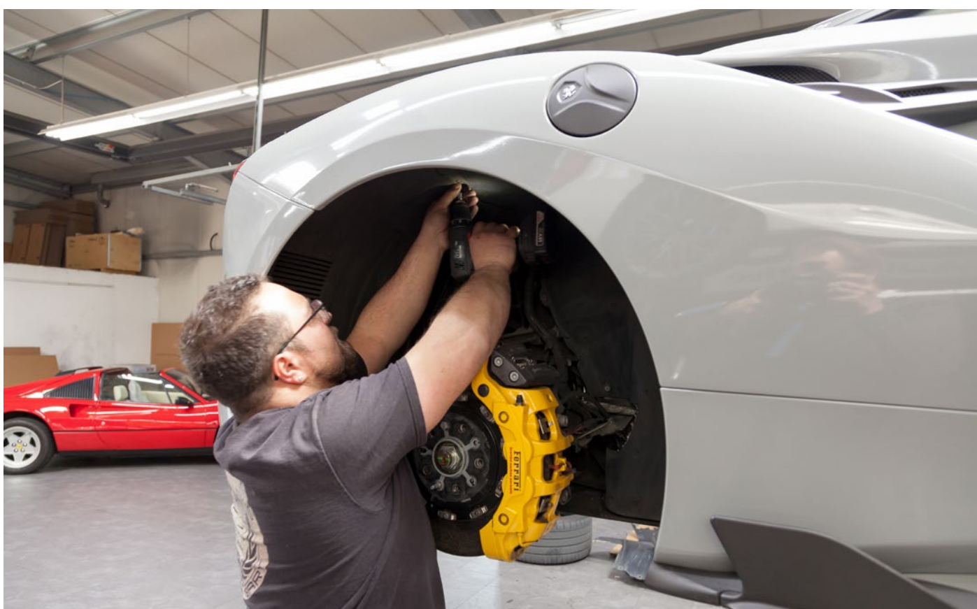
Radkastenauskleidungen entfernen. / Remove the wheel house liners.
