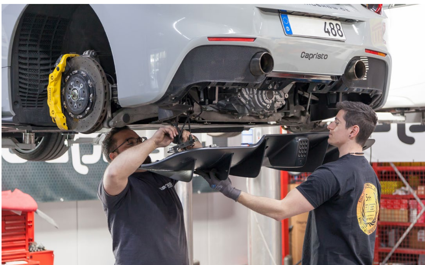
Lösen der Steckverbindungen nicht vergessen! / Remember to disconnect the plugs!
