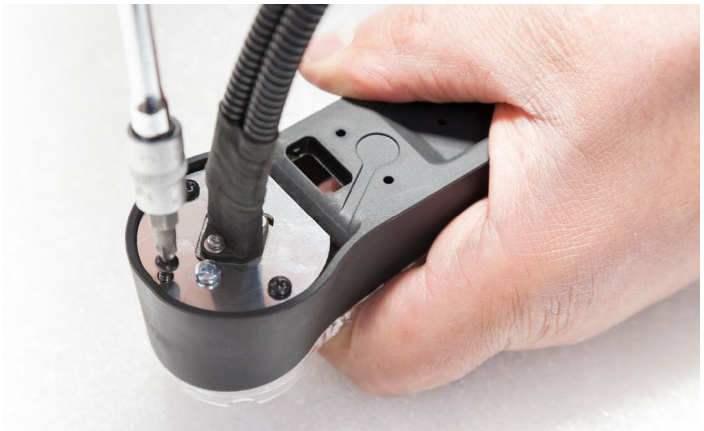
Vormontierte Kamera in der Aufnahme verschrauben. / Mount the cam unit into the cam bay.
