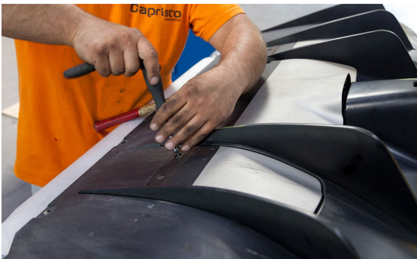
Klappen Abschrauben. / Demount the flaps.
