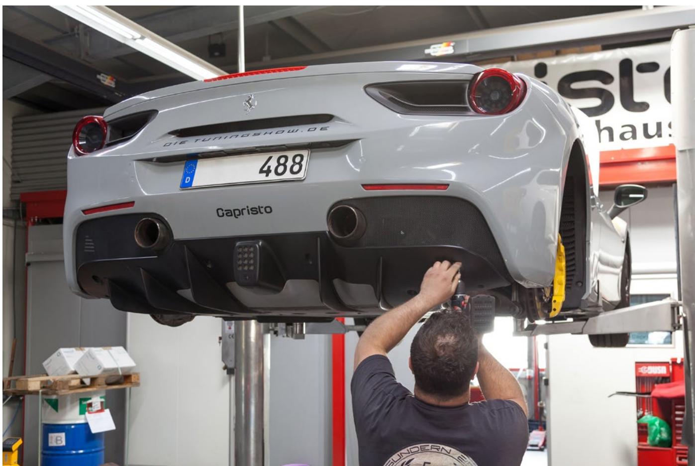
Diffusor abmontieren. / Remove the diffusor.
