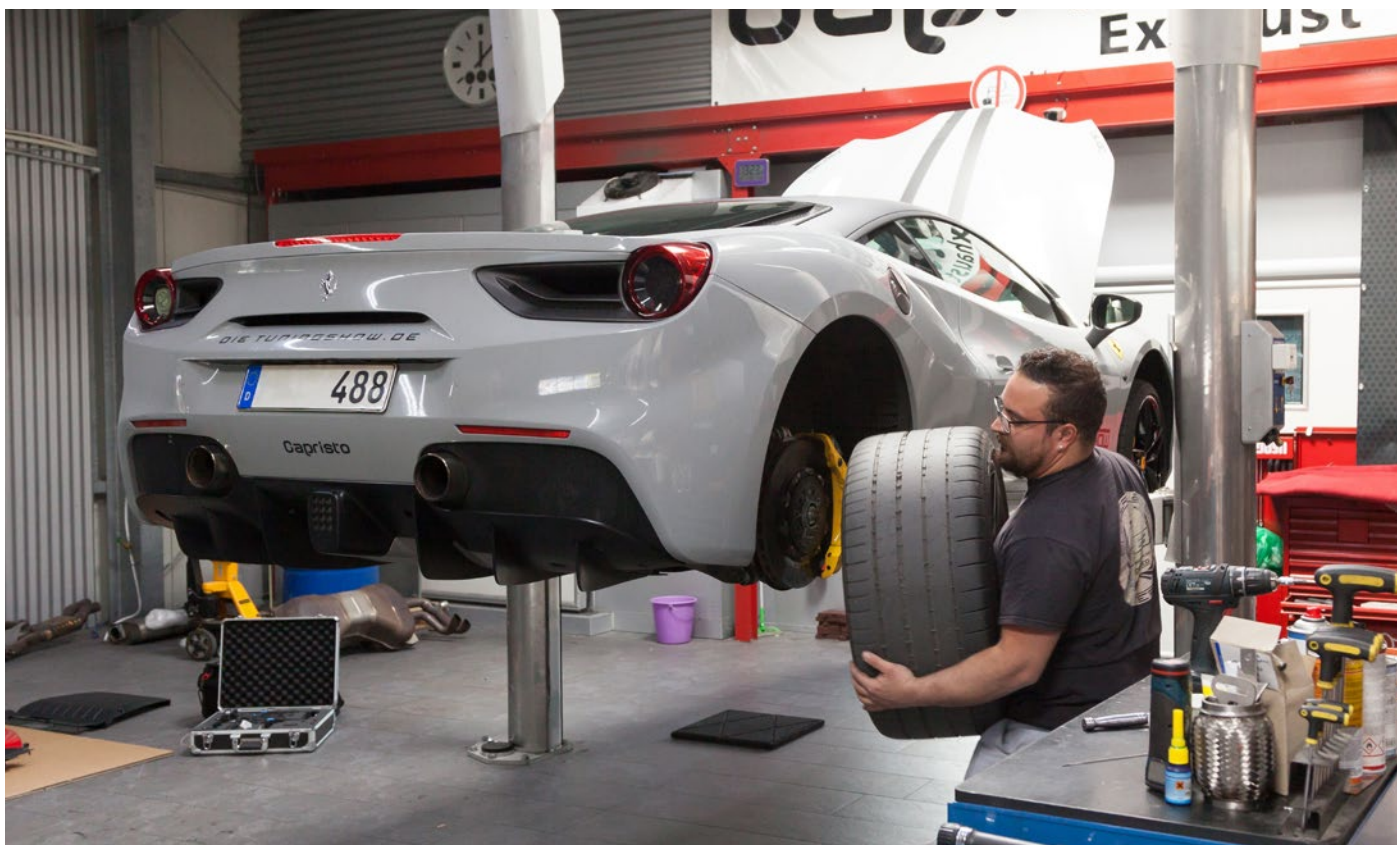
Räder hinten abmontieren. / Remove the rear wheels.
