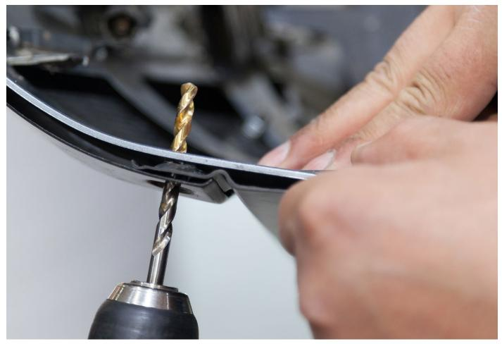
7. Drücken Sie die Teile weiterhin sorgfältig an und bohren Sie die beiden Löcher D 6.5 mm (vorbohren mit 3mm).
