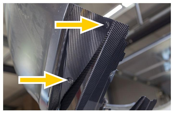
Die Seitenteile werden jetzt mit dem Hauptteil verschraubt. Zwei Einprägungen sind für Schrauben vorgesehen.
