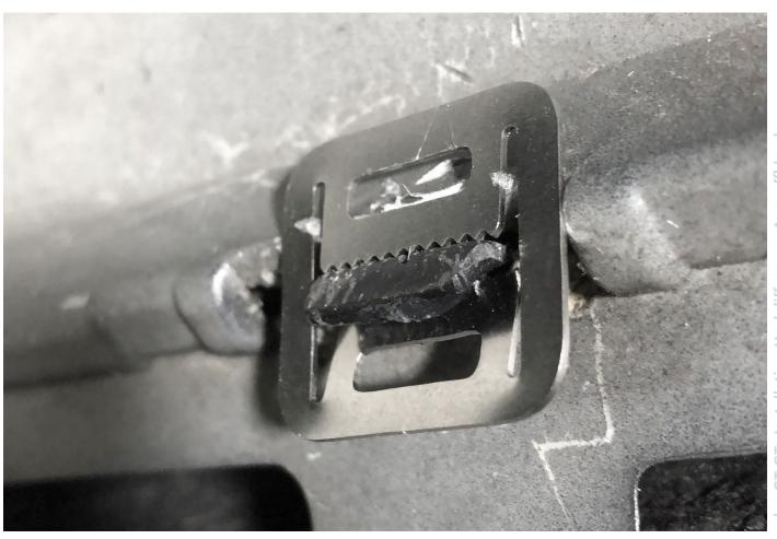
6. Fixieren Sie die Laschen wie gezeigt mit den beigefügten Stahlspangen.
