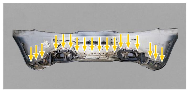
3. Clipse lösen, um die OEM-Carbonteile von innen nach außen herauszudrücken.
