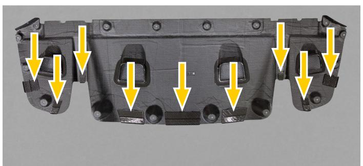
10. Jetzt die Bodenplatte montieren. Dieses Teil hat Laschen, die auf das Hauptteil aufgeschoben werden müssen:
