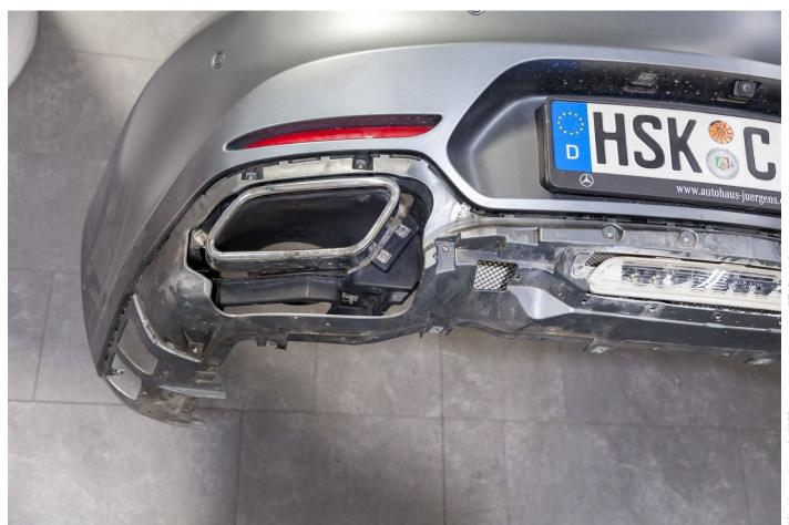
OEM-Carbonteile sind entfernt worden.
