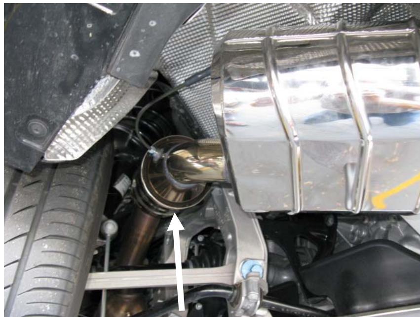
Katalysator, nicht für serienm. Euro 5 Fahrzeuge erforderlich / Catalytic converter, not necessary for series Euro 5 vehicles
